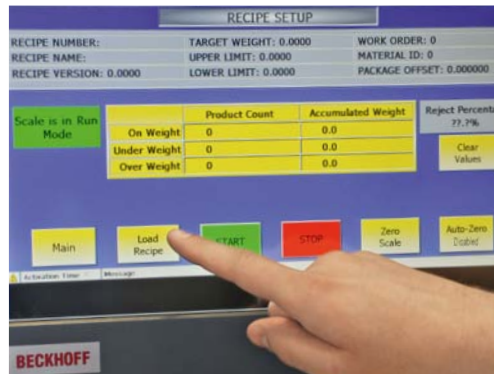
带 15 英寸触摸屏的 Beckhoff 的 CP6902 控制面板被用作称重系统的 HMI。
