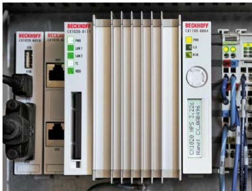
装有 TwinCAT PLC 自动化软件的 Beckhoff CX1020 嵌入式控制器和 EtherCAT I/O 用作 Friesen's 公司检验秤的控制平台。
